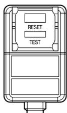
TEST : LORS DU COURANT DE FUITE OU SI LE BOUTON DE TEST EST PRESSE, LA LAMPE INDICATRICE S'ÉTEINT ET L'ALIMENTATION DE L'APPAREIL EST COUPEE.
